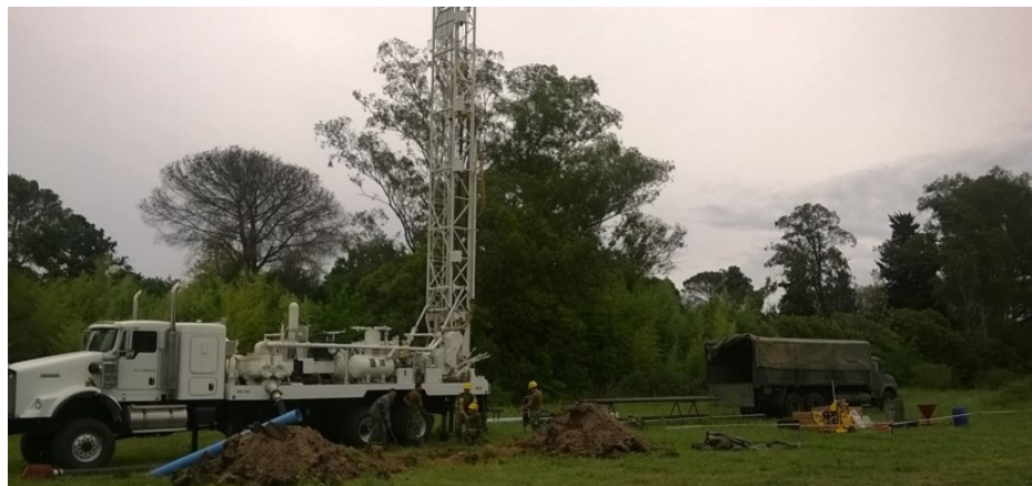
Equipo de Perforación GEFCO SS 22, sobre camión KENWORTH. Las facilidades que posee son la de realizar pozo de inspección/ explotación y análisis de suelo. (Fuente: Ca Ing Ag 601, Campo de Mayo)
