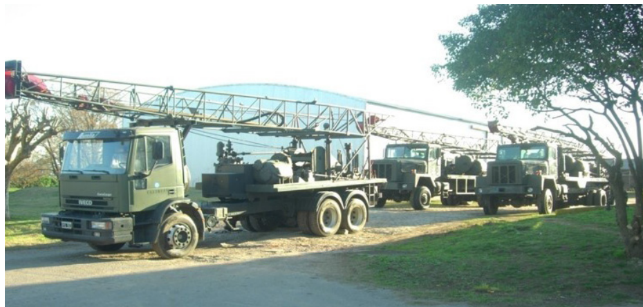
Equipo de Perforación FAILING, sobre camión IVECO. (Inspección y Mantenimiento de pozos de agua). (Fuente Ca Ing Ag 601. Campo de Mayo).
