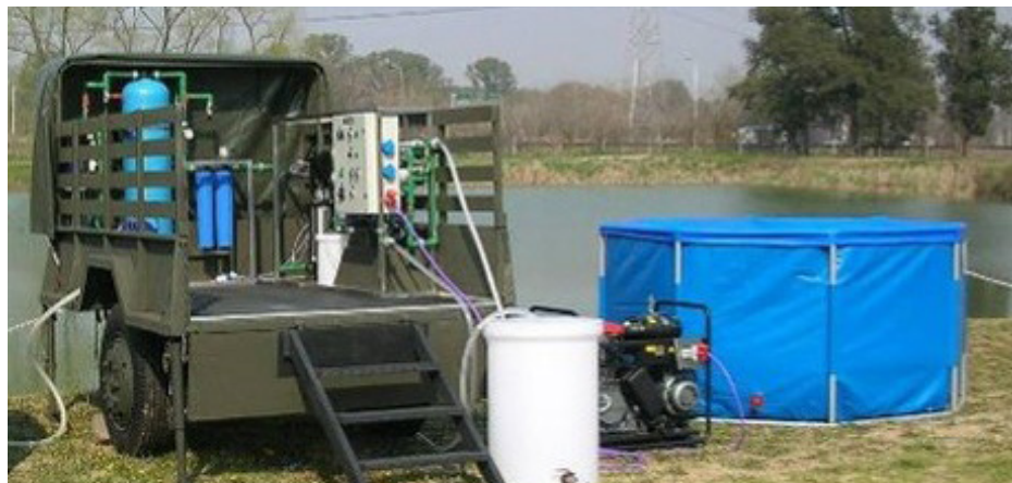
Planta Potabilizadora FOI. Filtración por Osmosis Inversa. (Desarrollada por el Ejército Argentino). (Fuente Ca Ing Ag 601. Campo de Mayo)
