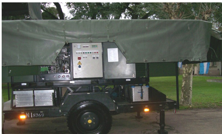
Planta potabilizadora de agua WATER CLEAR Mod 1600 GT. Sus características son: Equipo potabilizador de agua por osmosis inversa WATER CLEAR. Modelo: 1600 GT, de origen alemán ( KARCHER); montado sobre AR de un eje todo terreno; posee membranas de ósmosis de alta salinidad; con una capacidad de producción de agua potable de 1600 l/h y utiliza para su funcionamiento abastecimiento eléctrico autónomo (Grupo electrógeno motor diesel). (Fuente Ca Ing Ag 601. Campo de Mayo).
